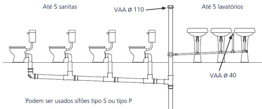
As válvulas de admissão de ar (VAA) de Ø110 mm são instaladas directamente na embocadura de um tubo de queda PVC-U de esgoto Série B Ø110. No caso de a instalação estar dimensionada com tubos de queda de Ø125, deverá ser utilizada a redução excêntrica 125/110 para instalar a VAA na boca do tubo PVC-U de esgoto Série B. Deverá ser tido em atenção o caudal de ar a ser calculado.
