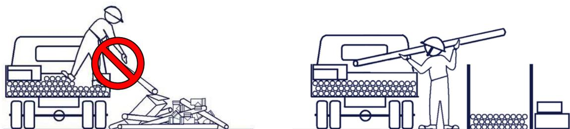
O manuseamento de atados ou de paletes requer o uso de equipamento mecânico apropriado. A técnica escolhida não deverá causar qualquer dano nos tubos.
