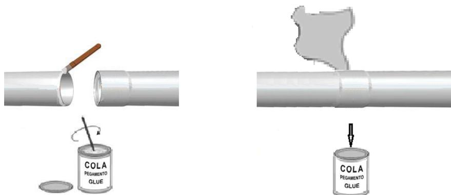
As colas à base de solventes fortes de PVC necessitam de um tempo de cura (após a colagem) longo a baixas temperaturas e curto a temperaturas elevadas. Não se recomenda que a colagem seja efectuada a temperaturas inferiores a 5 °C;
