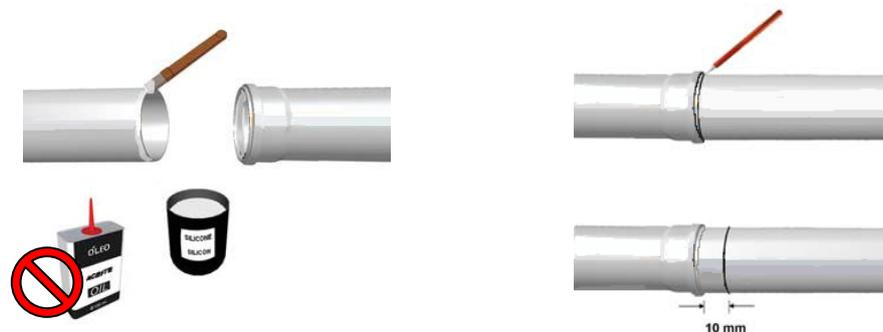
Após a lubrificação das duas superfícies, a introdução deve ser efectuada imediatamente para evitar o depósito de sujidade.
