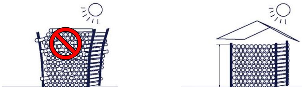
Os suportes laterais das paletes deverão ser colocados a intervalos máximos de 1,5 m. Os tubos devem ser suportados em todo o seu comprimento. Tubos de diferentes diâmetros e espessuras deverão ser armazenados separadamente. No caso de isto não ser possível, os de maior diâmetro e espessura deverão ser colocados no fundo.
