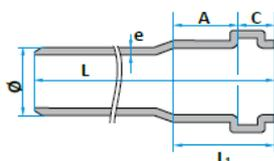
**Dimensões e tolerâncias para tubos e acessórios de PVC-U esgoto Série B com embocadura para o-ring (TD)**
